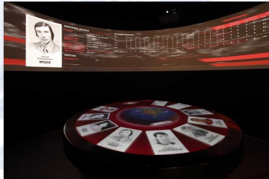
7 проекторов PT-DZ780BE, панорамная сшивка 318 градусов
