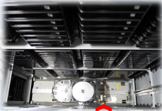
Транспортер картриджей внутри стойки (вид сверху)
